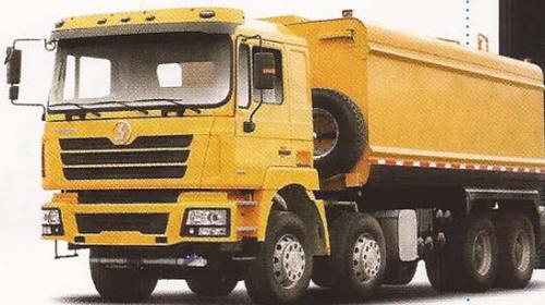
logrando alcanzar una potencia máxima de 385 caballos y se enmarca bajo la normativa Euro IV. Está asociado a una caja de cambios Eaton de 9 velocidades, cuenta con ejes traseros equipados con reductores de cubos con capacidad para 16.000 kilos cada uno, y doble eje direccional con caja ZF y capacidades de 9.500 kilos cada uno; para una máxima eficiencia en el frenado, incorpora freno auxiliar Jacob.
